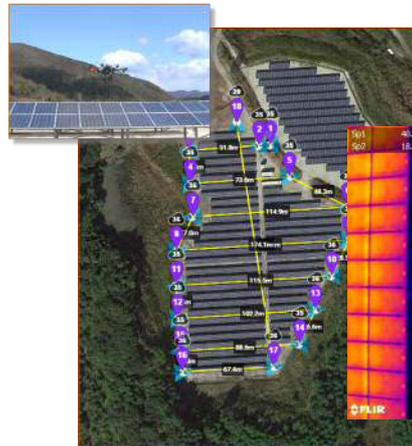
ホットスポット現象によるパネルの発熱を遠赤外線カメラで検知し、パネルの異常箇所を発見します。
