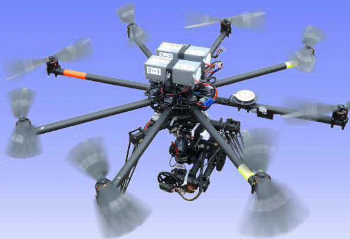
UAVは無人航空機の総称です。機体にはコンピュータを搭載し飛行の安全度と機動力を高め、自律航行を可能とした小型の無人航空機です。UAVにカメラや遠赤外線カメラを搭載し、今までは困難であった各種調査や情報収集が可能になりました。
