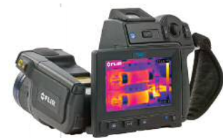
写真-9 熱赤外線カメラ外観 （Model: FLIR640）
