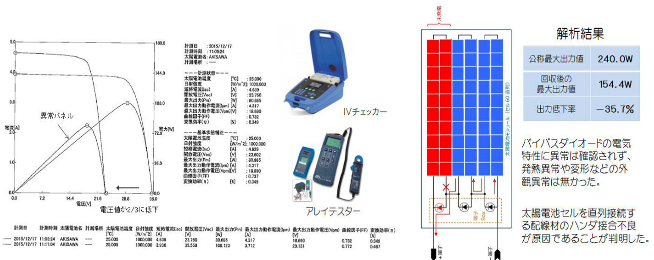
図 7. 異常パネルの現地計測結果と解析結果（日本エコシステム(株)提供資料）
