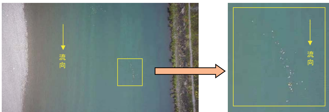
図-8 測定範囲上流部から流下させた木の葉を用いたトレーサー
