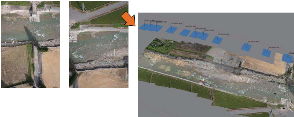
写真-4 UAV撮影画像による写真の正射投影化
